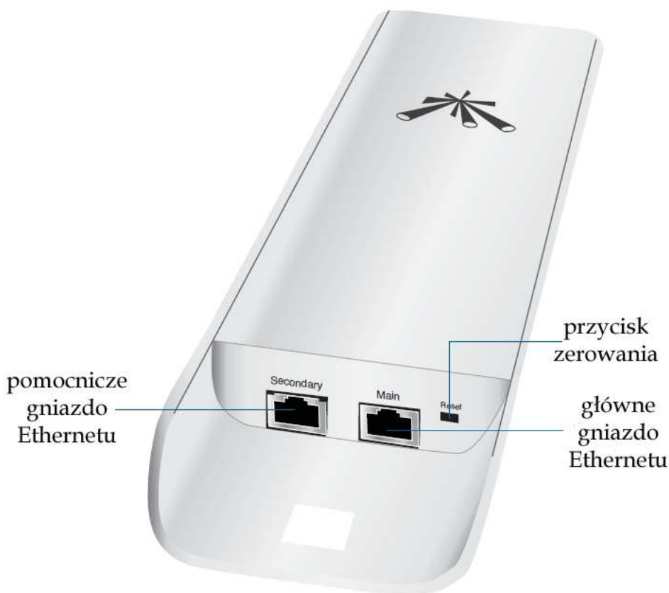
Rys. 3.1. Widok „Nanostation”. W drugie gniazdo Ethernetu są wyposażone jedynie modele M2/M3/M5. Do zasilania przez kabel ethernetowy należy użyć zasilacza 24 V. „Nanostation Loco” posiada tylko jedno gniazdo
