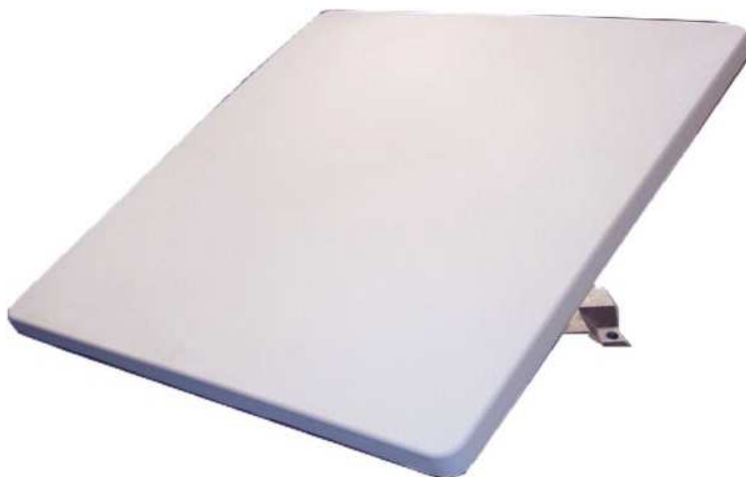
Rys. 2.13. Przykład konstrukcji anteny planarnej PA-5000-23 o zysku 23 dBi na pasmo 5,1 5,825 GHz (dla standardów 802.11a/n). Antena ma polaryzację liniową, szerokość wiązki w obu płaszczyznach 16^\circ , wymiary 322 x 322 x 12 mm i waży ok. 1360 g. Dopuszczalna moc doprowadzona do jej zacisków (gniazda N) wynosi 10 W. Zysk przystępnych anten planarnych na pasmo 2,4 GHz jest przeważnie trochę niższy i wynosi ok. 20 dBi. Anteny planarne stanowią praktyczną alternatywę dla rozpowszechnionych anten parabolicznych
