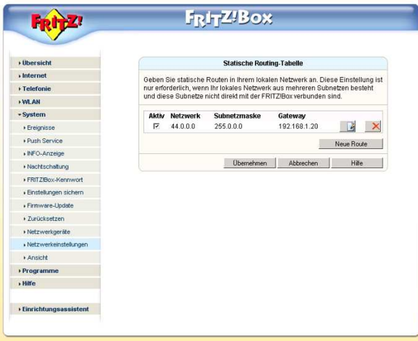
Rys. 3.13. Wpisanie trasy do domowego punktu dostępowego gdy sieć domowa zawiera podsieci nie połączone bezpośrednio z punktem dostępowym do Internetu
