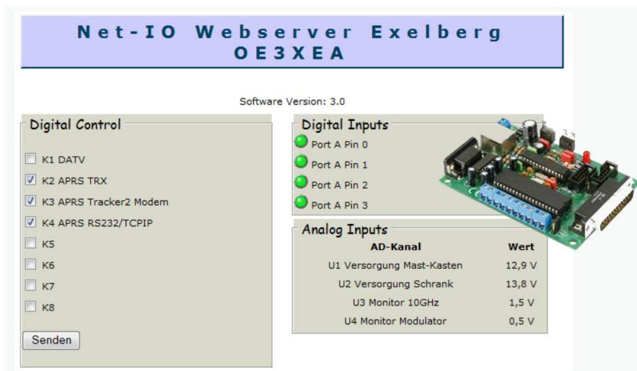
Rys. E.1. Przykład instalacji telemetrycznej i zdalnego sterowania na serwerze na przemienniku OE3XEA usytuowanym na górze Exelberg w pobliżu Wiednia. Serwer uruchomiony kilka lat temu jest oparty na mikrokomputerze „AVR-Net-IO”. Obecnie mamy do dyspozycji „Maliny”
