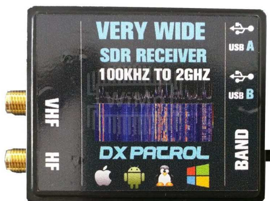
Rys. 2. Oparty na paluszku z RTL2832U i R820T szerokozakresowy odbiornik „DX Patrol”
