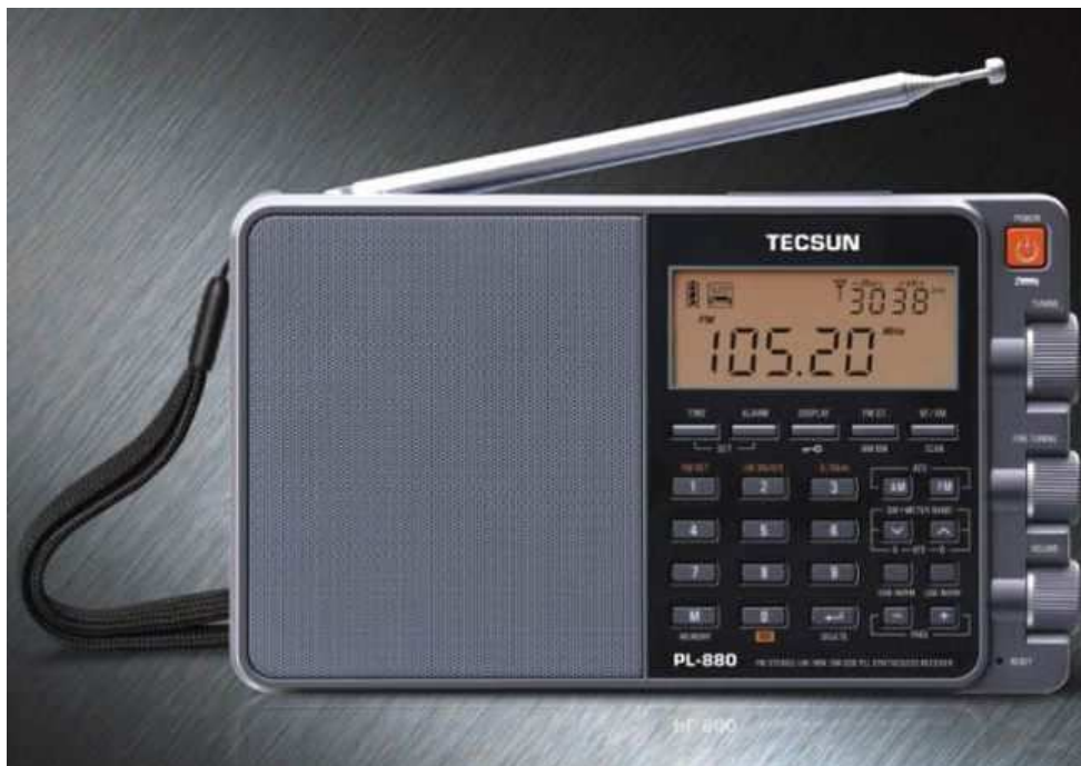
Fot. 8.12. Odbiornik Tecsun PL880 z cyfrową obróbką sygnałów pokrywa zakresy 100 kHz – 30 MHz i 64 – 108 MHz, dysponuje odbiorem SSB, kilkoma przełączanymi szerokościami pasma p.cz. dla AM i SSB oraz detektorem synchronicznym. Zastosowano w nim specjaną wersję obwodu SI4734
