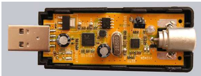
Fot. 3. Konstrukcja wewnętrzna odbiornika DVB-T często używanego przez krótkofalowców. Cyfrowa obróbka odebranych sygnałów odbywa się na PC albo na przenośnych komputerach androidowych w ich podsystemach dźwiękowych
