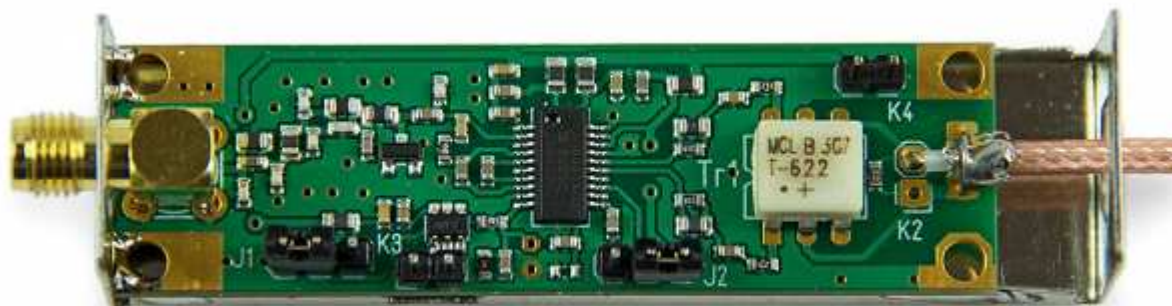
Rys. 10.5. Przedwzmacniacz do odbiorników na „Red Pitaii” [10.6] na obwodzie AD8331. Na wyjściu zastosowano transformator T-622 firmy „Micro Circuits” dający przekładnię 9:1
