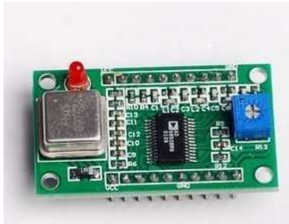
Fot. 6.7. Chiński moduł syntezy na AD9850. W góry widoczne są kontakty równoległego złącza sterującego, a u dołu wyjścia fal sinusoidalnej i prostokątnej. Generator częstotliwości zegarowej znajduje się po lewej stronie. Do sterowania modułu można użyć „Arduino”
