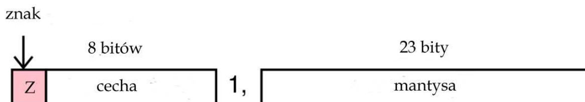
Rys. 1.9. Przykład reprezentacji zmiennoprzecinkowej przy użyciu słowa 32-bitowego. Wartość liczby oblicza się jako X = (-1)^Z * 2^{C-127} * 1,M ; gdzie Z jest znakiem, C – 8-bitową cechą, a M – 23-bitową mantysą (częścią ułamkową). W tym przykładzie zakres liczbowy leży w przybliżeniu pomiędzy 10^{-38} i 10^{38} . W reprezentacji 64-bitowej mantysa ma długość 52 bitów, a cecha 11
