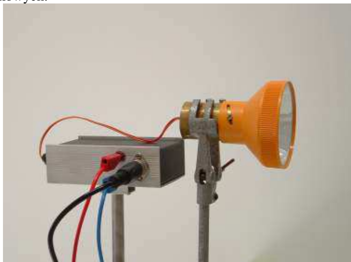
Fot. 2.1.2. Konstrukcja nadajnika z wykorzystaniem reflektora od latarki. Od frontu widoczne jest gniazdko diodowe (DIN) dla sygnałów m.cz. i gniazdko bananowe do podłączenia zasilania
