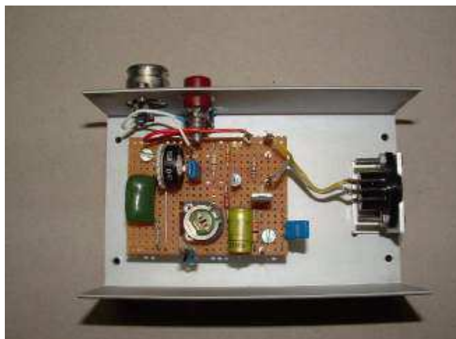
Fot. 2.1.3. Płytką nadajnika we wnętrzu obudowy. Po prawej stronie znajduje się gniazdko do podłączenia diody nadawczej
