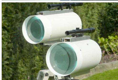
Zdjęcia 6.2.1. Szczegóły konstrukcji mechanicznej: a – widok gotowej konstrukcji, b – soczewka, c – rura kanalizacyjna, d, e – ścianka poprzeczna do zamontowania fotodiody, f – montaż fotodiody w otworze, ścianka umieszczona w ognisku soczewki, g – widok ścianki wewnątrz rury, h – podstawka do montażu układu elektronicznego, i – podstawka połączona z tylną ścianką, j – tylna ścianka, widoczne gniazdko dla mikrofonu i słuchawek, l – montaż diody laserowej na profilu aluminiowym, m – nadajnik i odbiornik obok siebie, n – nadajnik i odbiornik na wspólnym statywie.
