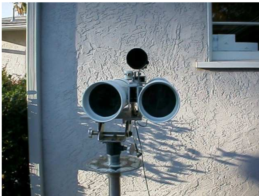
Fot. 3.2.3. Przykład konstrukcji mechanicznej stacji nadawczo-odbiorczej
