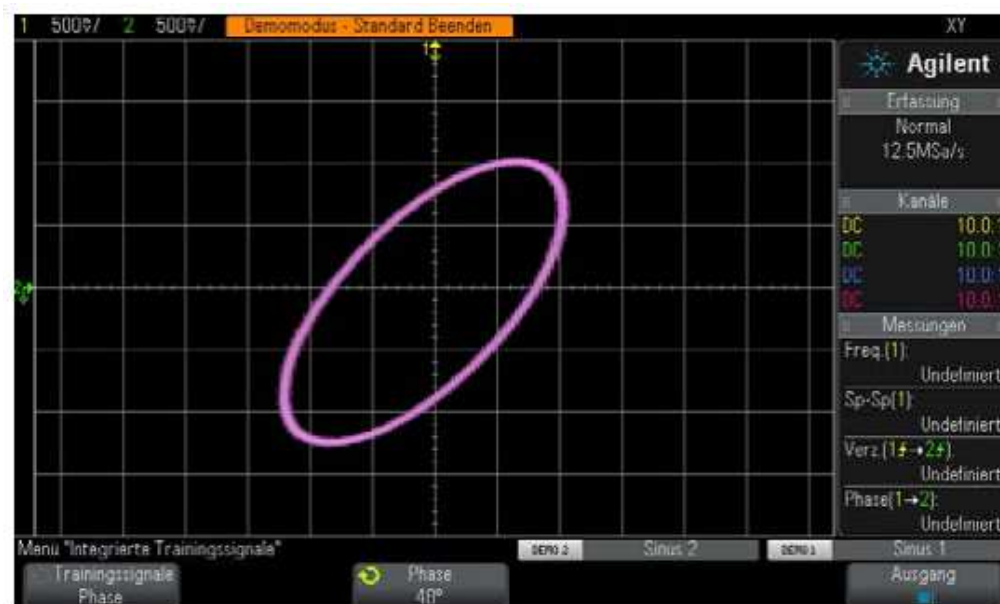
Rys. 8.0.3. Figura Lissajous otrzymana w trybie wyświetlania XY. Stosunek częstotliwości f_y do f_x oblicza się odczytując liczbę przecięć z osią Y lub inną wybraną pionową linią podziałki i dzieląc przez liczbę przecięć osi Y lub innej wybranej poziomej linii podziałki
