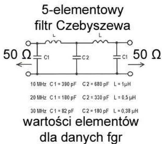
Rys. B.7. Filtr Czebyszewa o częstotliwościach granicznych 10, 20 i 30 MHz
