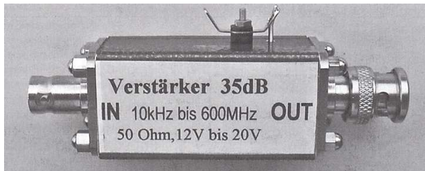
Fot. C.3. Wzmacniacz w obudowie. U góry widoczne doprowadzenie zasilania
