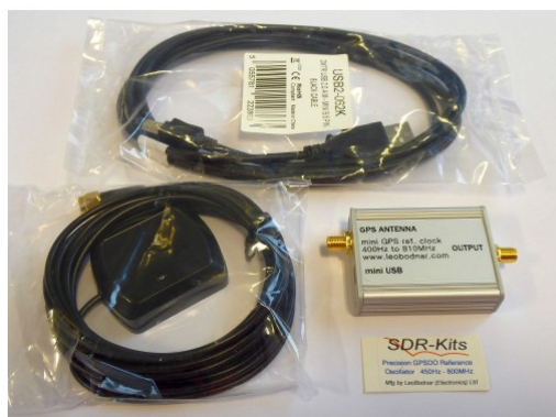
Fot. D.2. Wzorec częstotliwości wraz z anteną GPS i kablem zasilającym
