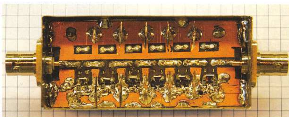
Fot. A.6. Widok płytki w obudowie od dołu. Obudowa ma wymiary 78 x 34 mm
