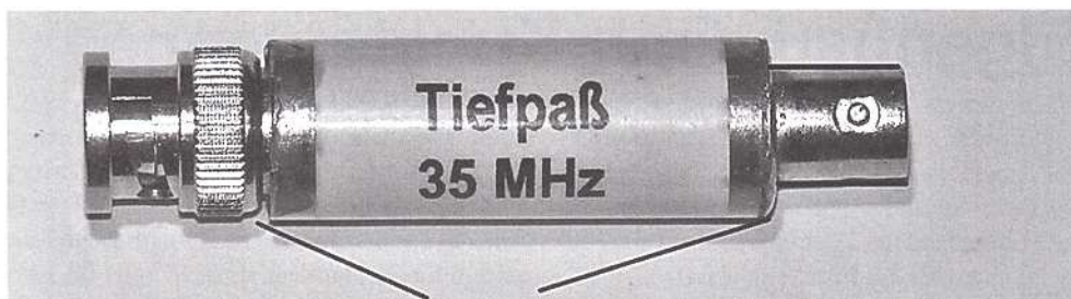
Fot. B.4. Filtr 35 MHz w obudowie z rurki miedzianej. Kreskami widocznymi u dołu zaznaczono miejsca przylutowania gniazd BNC do rurki (źródło [5])
