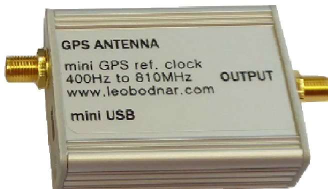
Fot. D.1. Wzorec jednosygnalowy o zakresie 400 Hz – 810 MHz
