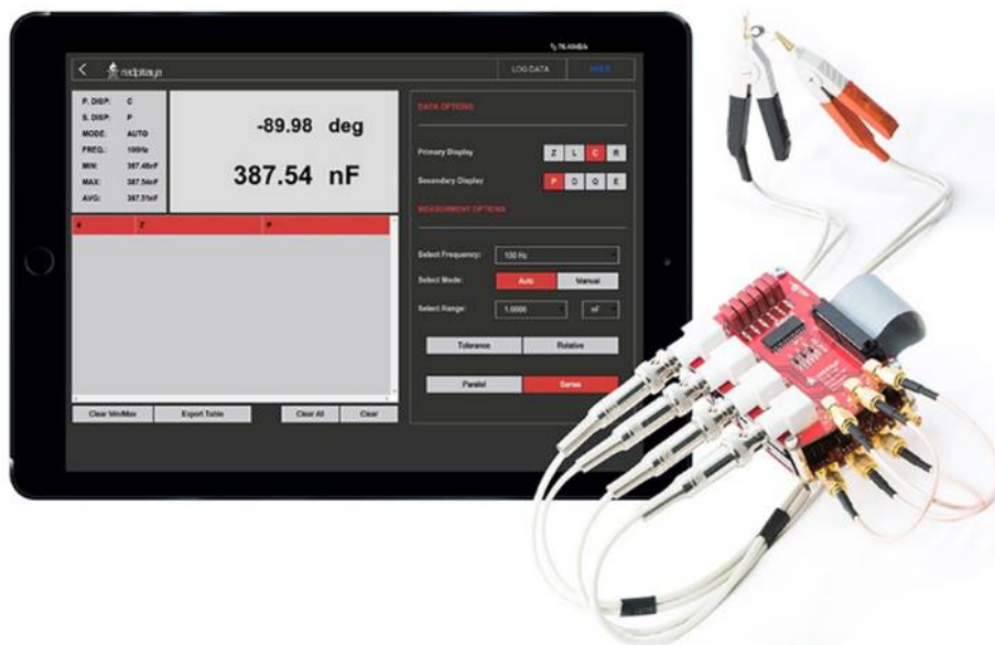
Fot. 11.9. Miernik oporności, indukcyjności, pojemności i impedancji
