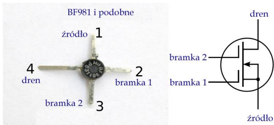
Rys. 3.8. Dwubramkowy tranzystor polowy – tetroda półprzewodnikowa
