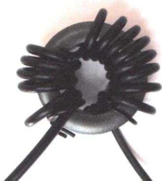
Fot. 3.4.6. Wykonanie dławika fali powierzchniowej z kabla RG174
