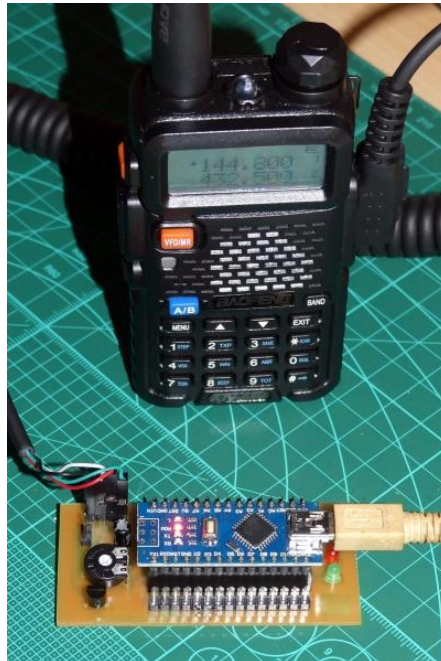
Fot. 3.1.2.2. Modem APRS podłączony do ręcznej radiostacji
