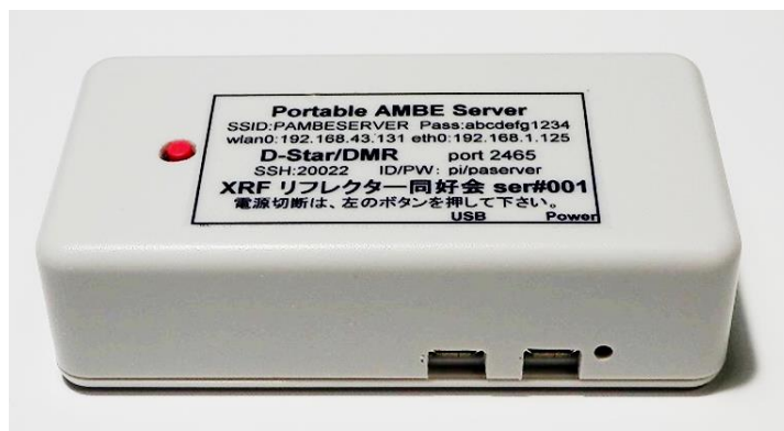
Fot. 1.3.8. Portable AMBE Server składa się z Maliny z dodaną płytką wokodera
