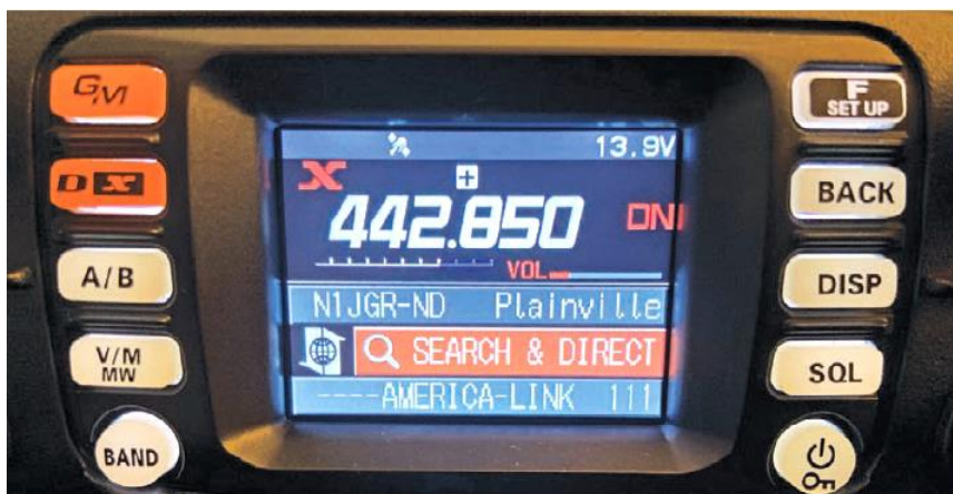
Fot. 5.3. Wybór dalszego połączenia przez WIRES-X (patrz [5.3])
