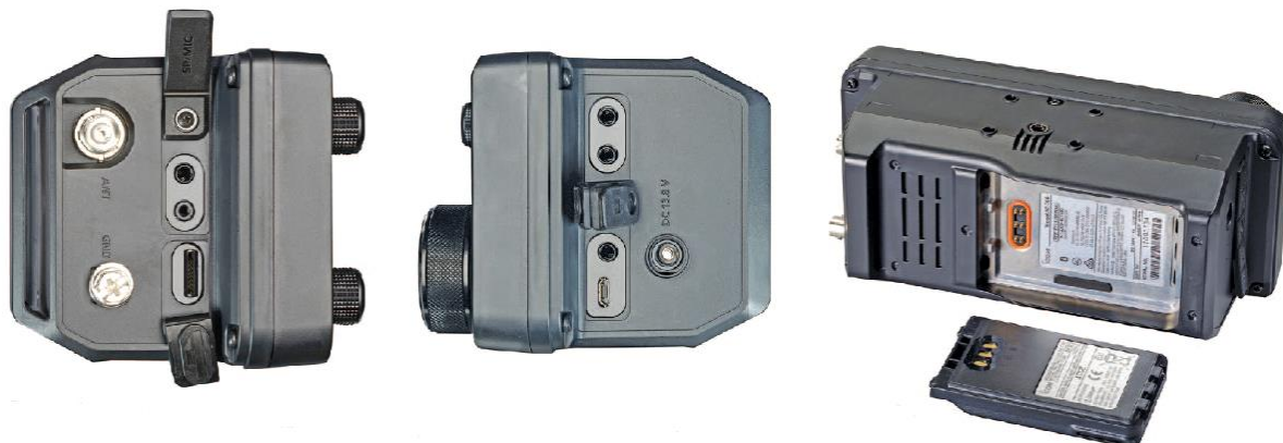
Fot. 1.1. Gniazdka dla anteny, mikrofonu, klucza telegraficznego i innych urządzeń są rozmieszczone na bocznych ściankach obudowy. Są one chronione przed wpływem wody i wilgoci przez gumowe przykrywkę
