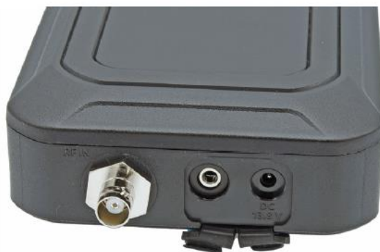
Fot. 2.2. Po jednej stronie obudowy AH-705 znajdują się gniazdko BNC do połączenia z radiostacją oraz gniazdko do sterowania i zasilania z zewnętrznego zasilacza. Oba gniazdko są chronione przed wilgocią przez gumowe przykrywkę, jeżeli nie są używane
