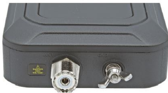
Fot. 2.3. Po drugiej stronie obudowy znajduje się gniazdko koncentryczne do podłączenia anteny i zacisk uziemienia
