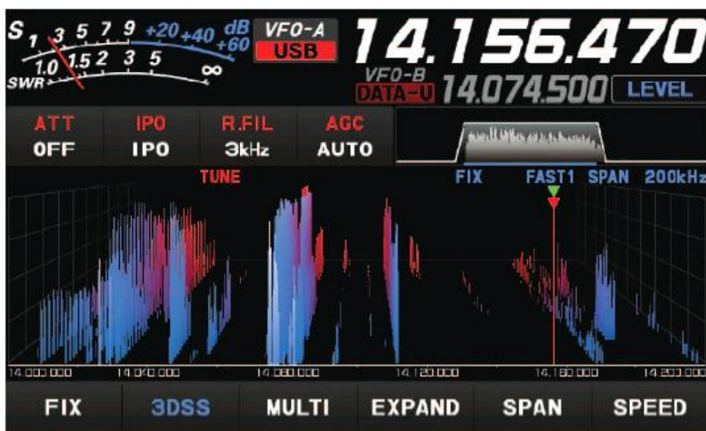
Fot. 4.3. Fascynujący trójwymiarowy wyświetlacz widma ilustruje na bieżąco zmiany sytuacji na paśmie. Oprócz tego do dyspozycji jest klasyczny wskaźnik wodospadowy
