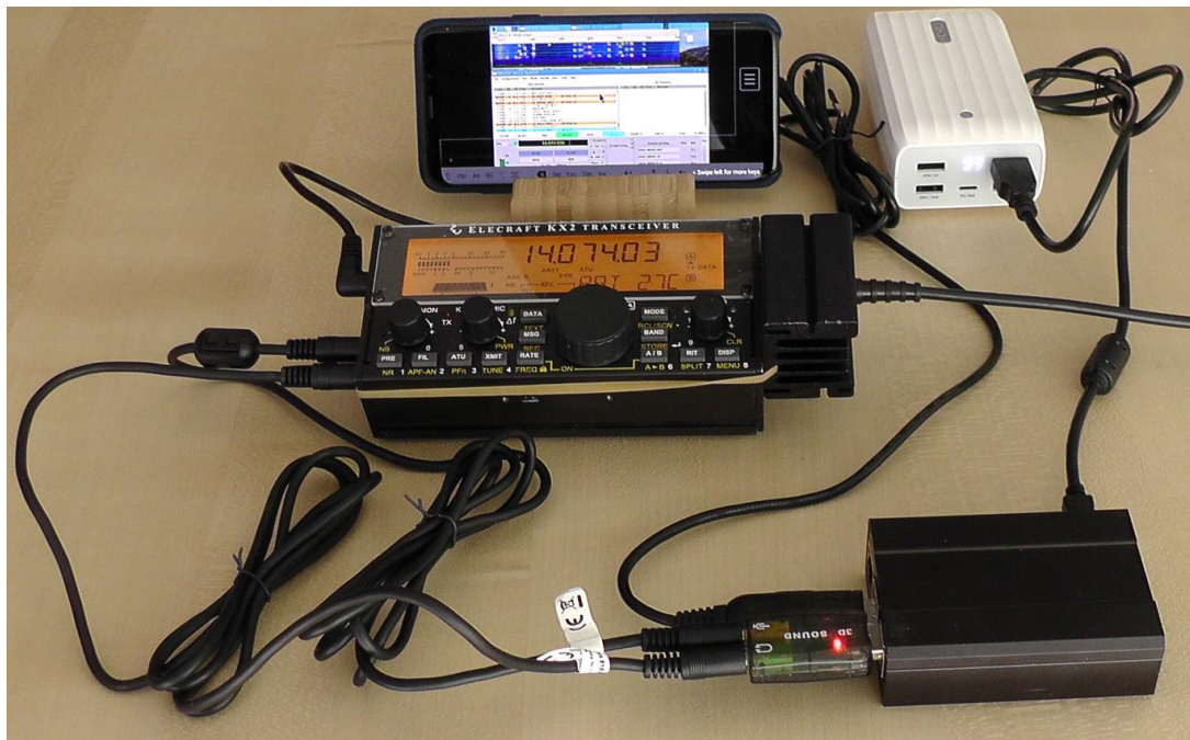
Fot. A.1. Kompletnie wyposażenie do pracy terenowej. Oprócz radiostacji KX2 składają się na nie modem FT8-Box, telefon androidowy i akumulator 5 V. FT8 jest emisją o stałej obwodni dlatego też radiostacja posiada dodatkowy radiator zapobiegający jej przegrzaniu
