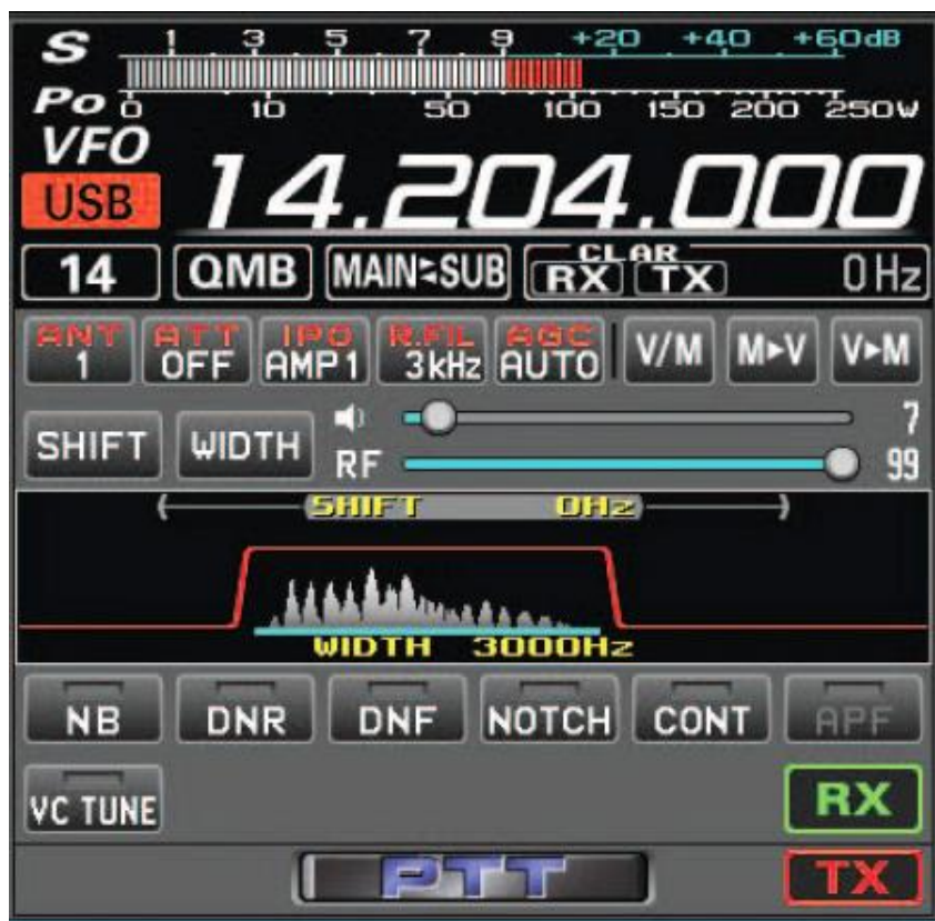
Fot. 7.3. W oknie programu sterującego można zmieniać częstotliwość pracy, emisję, filtry, regulować tłumienie szumów, przełączać szybkość reakcji ARW i nastawiać wiele innych parametrów i korzystać z wielu funkcji
