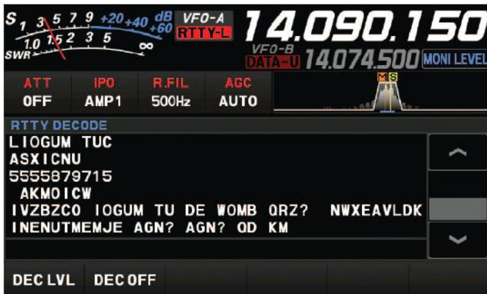
Fot. 4.4. Dekodowanie sygnałów RTTY. Dekoder próbuje wprawdzie prawidłowo zdekodować odbierane sygnały, ale nie zawsze z dobrym skutkiem. Po prawej stronie u góry obok wskaźnika ARW („AGC”) znajduje się wskaźnik częstotliwości znaku i odstępu RTTY mający ułatwić dostrojenie
