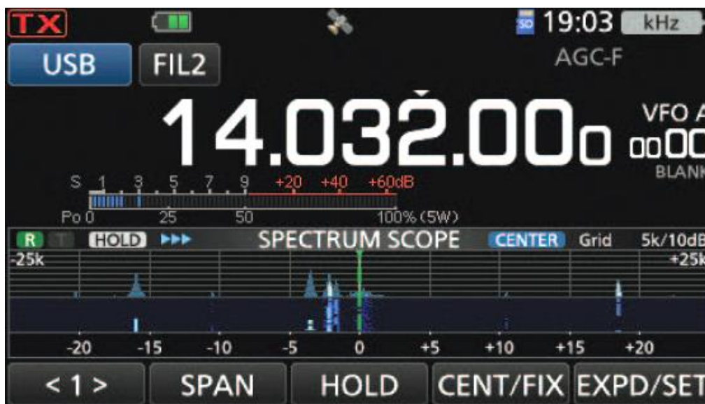
Fot 1.2. Aktywność w paśmie 20 m przedstawiona na wskaźniku widma IC-705
