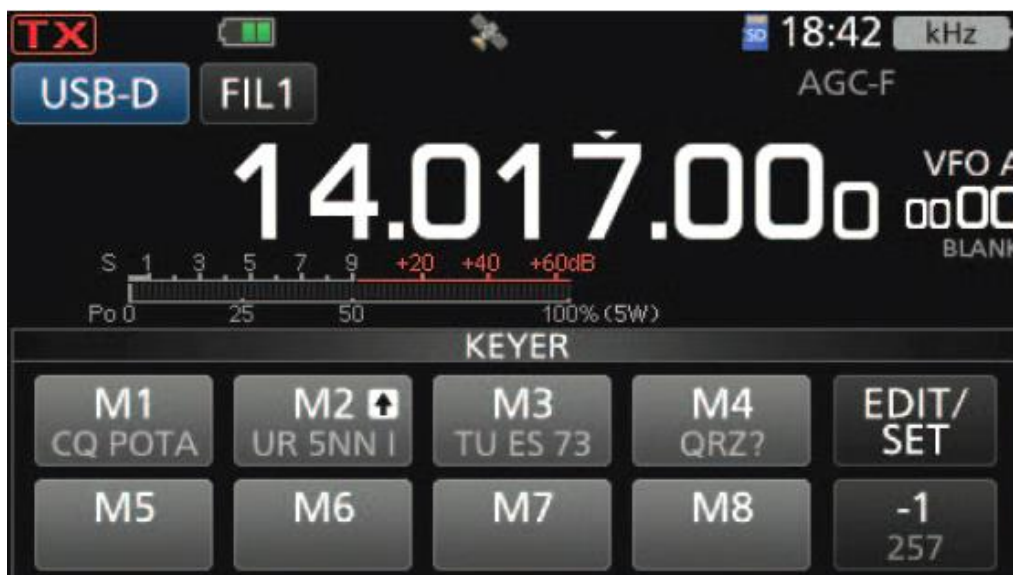
Fot. 1.3. Pamięci komunikatów telegraficznych ułatwiają pracę w czasie większej aktywności
