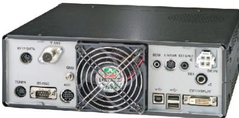
Fot. 4.2. Na tylnej ścianie obudowy znajdują się gniazda umożliwiające podłączenie różnych urządzeń dodatkowych. Pojedyncze gniazdko antenowe nie pozwala na korzystanie z oddzielnej anteny odbiorczej. W czasie odbioru wentylator jest włączany i wyłączany przy małej szybkości obrotowej
