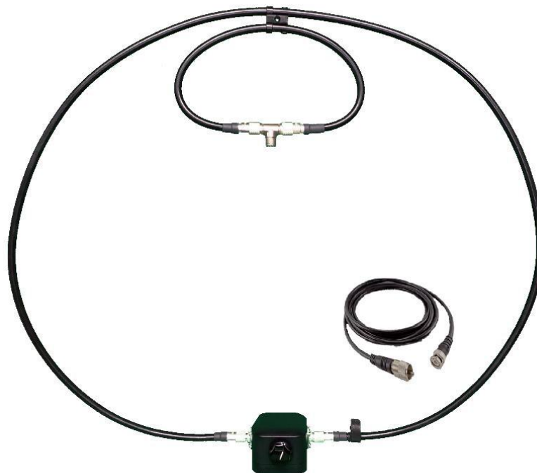
Fot. 1.10. Antena magnetyczna AL-705 pokrywa pasma 10 – 40 m (7 – 29,7 MHz). Jest ona ręcznie dostrajana do częstotliwości pracy. Średnica w stanie rozłożonym wynosi 67 cm, masa 860 g, a dopuszczalna moc doprowadzona – 20 W PEP (dla CW i emisji cyfrowych 10 W). Do anteny dodawany jest 3-metrowy kabel zasilający z wtyczkami BNC i PL-259 (UHF) na końcach. W stanie złożonym antena mieści się w plecaku LC-192
