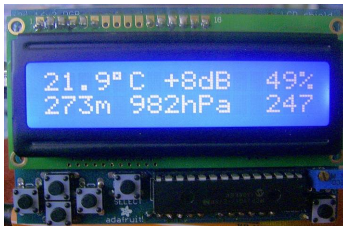
Fot. 1.11. Transmisja danych meteorologicznych: ciśnienia, temperatury, wilgotności względnej i wysokości zmierzonych za pomocą czujnika BME280 firmy „Bosch”. Dodatkowo wyświetlana jest informacja o sile odbieranego sygnału (odstępie poziomu sygnału od szumu)
