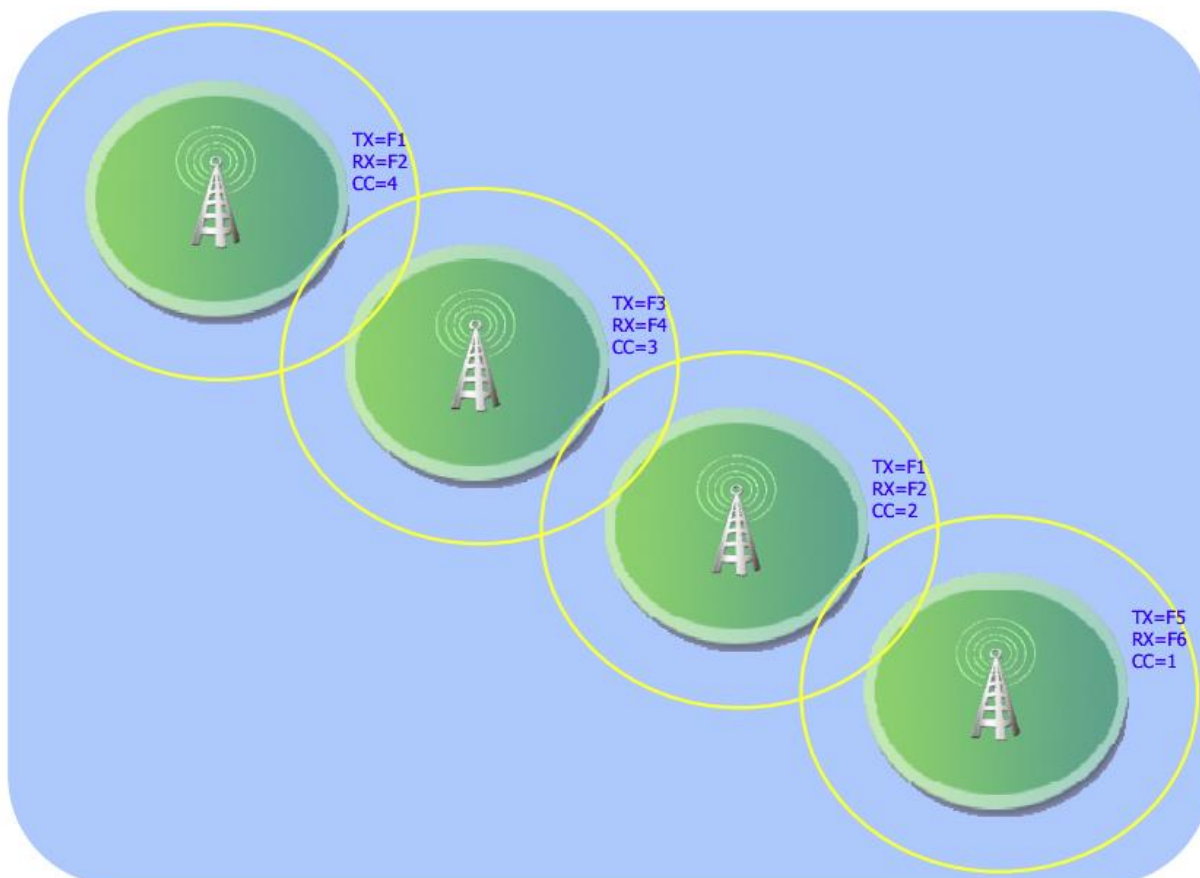
Rys. 3.1. Przykładowe rozmieszczenie przemienników na trasie ruchu stacji. Ich zasięgi częściowo zachodzą na siebie dzięki czemu możliwe jest prowadzenie łączności bez przerw. Ich częstotliwości pracy i kody CC mogą się różnić, ale wszystkie muszą pozwalać na korzystanie z jednej i tej samej grupy
