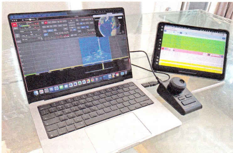
Rys. 7.4. Zdalne sterowanie przez MacBook Pro z gałką RC-28 i iPadem Pro jako drugim monitorem w trakcie łączności FT8
