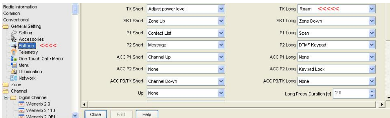
Rys. 3.4. Programowanie przycisku służącego do włączania funkcji przenoszenia
