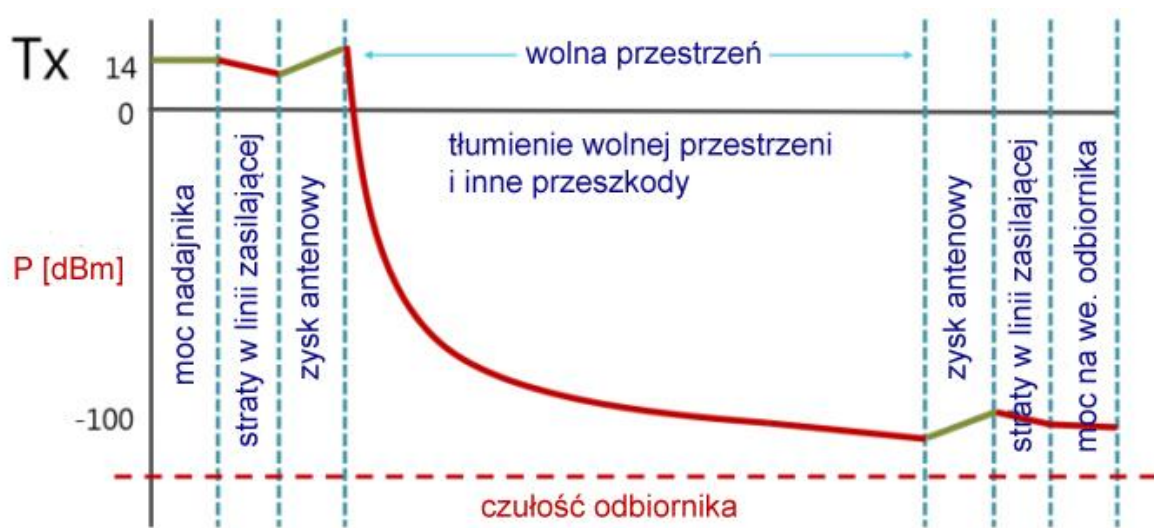
Rys. 5.4. Przykładowy bilans energetyczny w sieci LoRa
