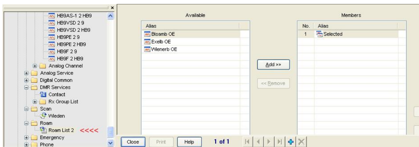
Rys. 3.2. Spisy kanałów dostępnych do wyboru i wybranych dla funkcji przenoszenia rozmów w programie CPS Hytery
